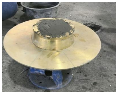
شکل ۴ آزمایش میز فلو بر روی بتن تازه
